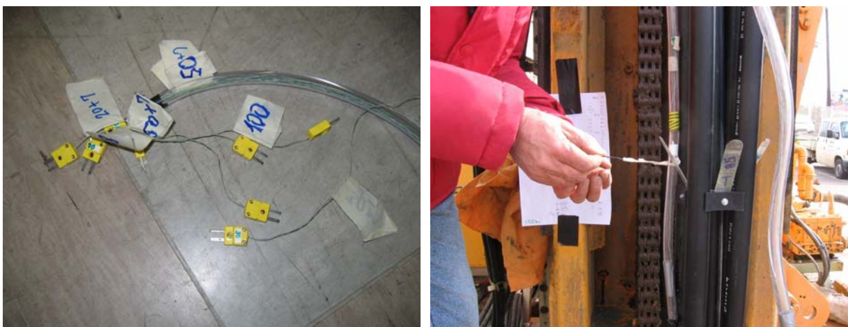
Slika 5. a) Priprema temperaturne sonde s termoparovima; b) Pozicioniranje termopara prilikom polaganja sonde
